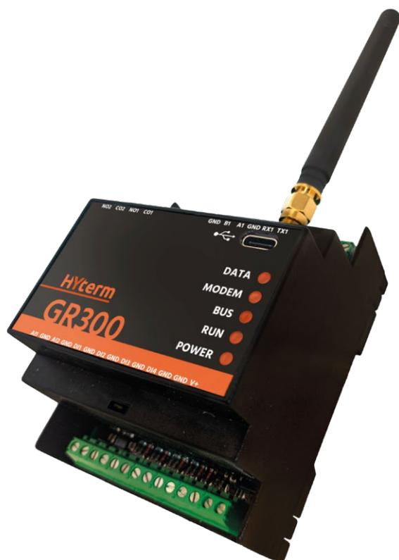
GR300 è la soluzione per il telecontrollo, l'accesso remoto ed il monitoraggio di scambiatori di calore a pacco alettato e impianti di ventilazione. GR300 raccoglie e storicizza misure, dati ed informazioni, controlla lo stato ed il funzionamento di macchinari e impianti da remoto.
